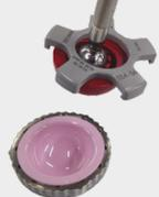
**9** Retirer le système et ne pas oublier d'impacter l'insert dans la cupule
