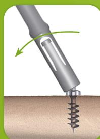
Incliner le tournevis jusqu'à la rupture de la partie sécable.
