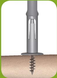
Position vissage : la tête est totalement enfoncée dans le tournevis.
